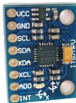
Figura 11: Sensor acelerómetro MPU-6050.
