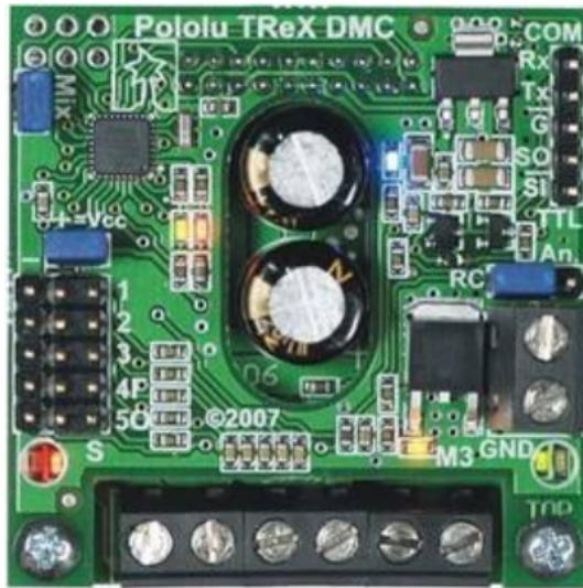
Figura 4: Tarjeta de potencia para el control de los dos motores de corriente directa.
